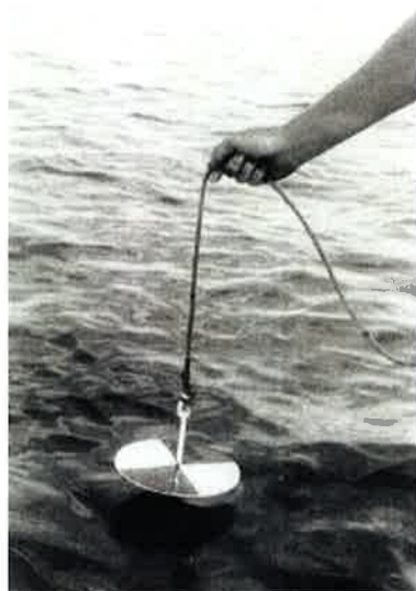
Figura 8. Disco de Secchi, equipamento utilizado para análise de turbidez e transparência nos viveiros de produção.
